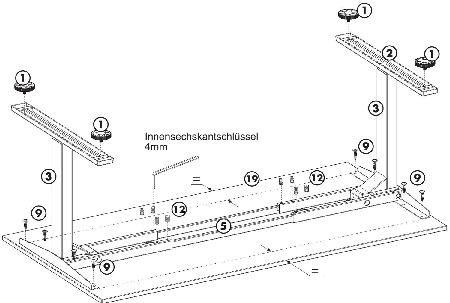
Der Oberrahmen des Schreibtischgestells ist in der Breite stufenlos teleskopierbar, in den Abmessungen 1200 -1800mm. Daher ist dieser Oberrahmen für Tischplattenabmessungen von:
